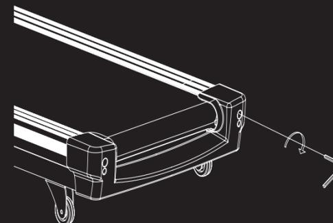
SE A LONA SE MOVER PARA A ESQUERDA, GIRE OS PARAFUSOS DO LADO ESQUERDO ¼ GIRE NO SENTIDO HORÁRIO, ENTÃO GIRE O PARAFUSO DIREITO ¼ GIRE NO SENTIDO HORÁRIO. SE A LONA NÃO SE MOVER, REPITA ATÉ CENTRALIZAR.
