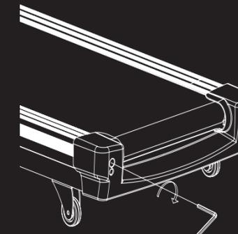
COM O TEMPO, A LONA VAI SOLTAR. PARA APERTAR A LONA, GIRE OS PARAFUSOS ESQUERDO E DIREITO UMA VOLTA COMPLETA NO SENTIDO HORÁRIO, VERIFIQUE A TENSÃO DA LONA. CONTINUE O PROCESSO ATÉ QUE A LONA ESTEJA NA TENSÃO CORRETA. ASSEGURE-SE DE AJUSTAR AMBOS OS LADOS IGUALMENTE PARA O ALINHAMENTO CORRETO DA LONA.
