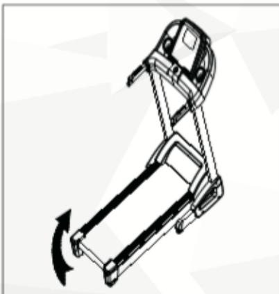
Levante a máquina e empurre para cima até ouvir um “click” emitido pela trava de segurança presa ao cilindro pneumático.
