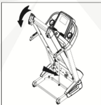
Para retroceder, empurre com o pé a trava de segurança puxando a máquina para baixo ao mesmo tempo (conforme indicam as setas). Em seguida a máquina irá abaixar lentamente.
